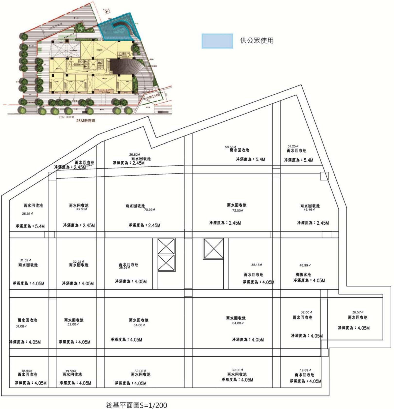
圖 10-10 筏基設置雨水回收再利用設施示意圖
