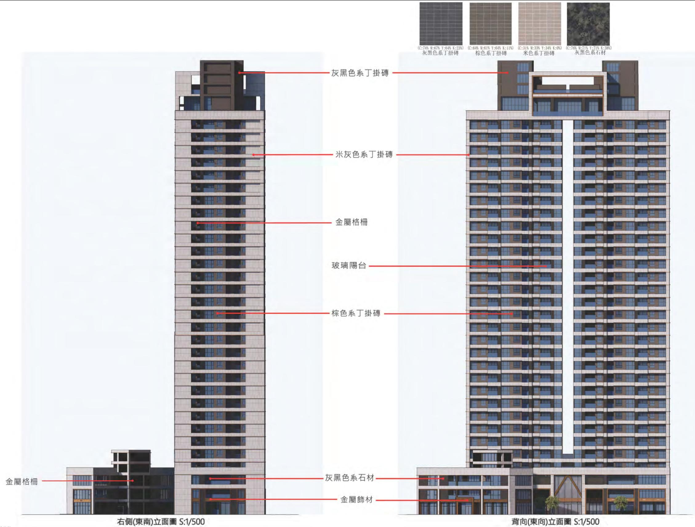
圖 12-3 建築物造型、外牆材質及色彩計畫(二)
